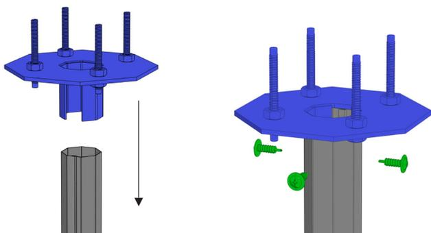
Возьмите опорный фланец и опорный столб. Вставьте опорный фланец в столб и закрепите с помощью саморезов.
