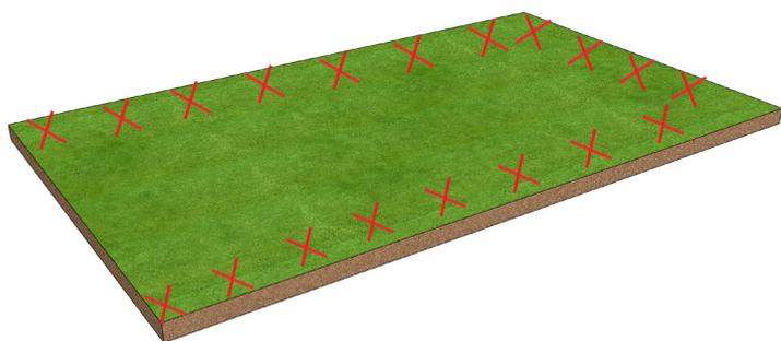
Разметьте площадку под установку ограждения. Отметьте места установки опорных столбов. Расстояние между столбами определяется межосевым расстоянием ограждения.
