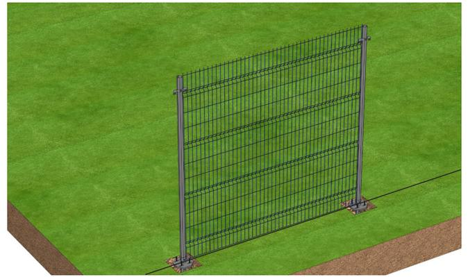
Установите две опоры с фланцем в подготовленные отверстия. Проверьте их по уровню и высоте, а также межосевые расстояния. Максимально допустимое расхождение составляет 1 см. Установите несущие столбы на опоры и навесьте секцию. Выставьте ограждения по уровню и высоте. Для верного монтажа воспользуйтесь натянутой нитью (веревкой).
