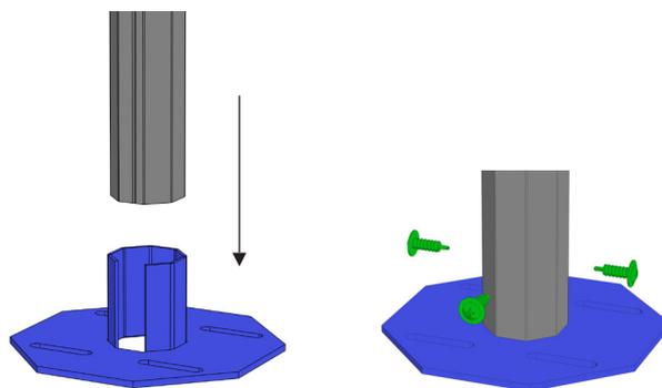
Возьмите несущий фланец и несущий столб. Вставьте несущий фланец в столб и закрепите с помощью саморезов.
