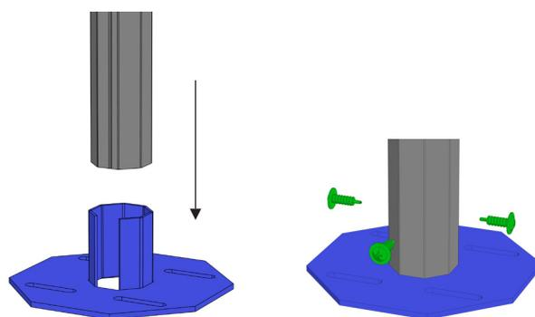
Возьмите несущий фланец и несущий столб. Вставьте несущий фланец в столб и закрепите с помощью саморезов.
