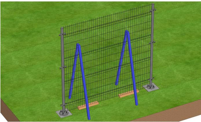
Закрепите секцию ограждения с помощью деревянных распорок и брусков. Засыпьте опоры щебнем и залейте бетоном.
