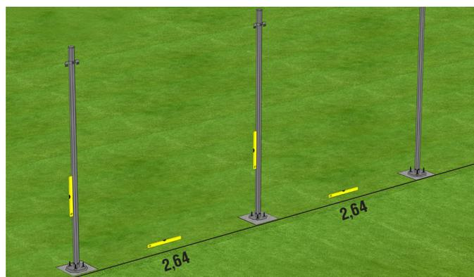
Установите все несущие столбы на опоры и закрепите с помощью регулировочных винтов, гаек. Засыпьте щебнем и залейте бетоном. Для ровного монтажа столбов (опор) воспользуйтесь натянутой нитью (веревкой). Соблюдайте вертикальность, высоту и расстояние между ними.
