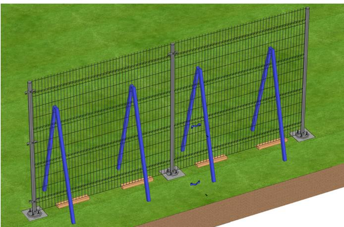
Установите оставшиеся скобы на первый и на средний столбы, закрепив установленные секции. Нижняя скоба должна быть установлена подвесом вверх.
