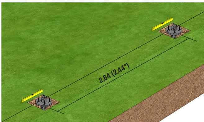
\* При ширине секции 2350 мм
